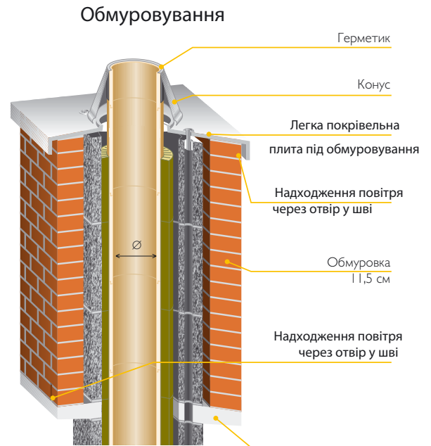
Виконувана на місці обмуровка на консольній плиті
